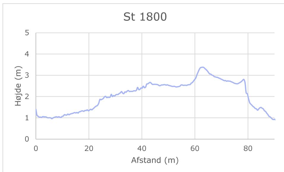
Figur 15 Tværsnit af diget St 1800
