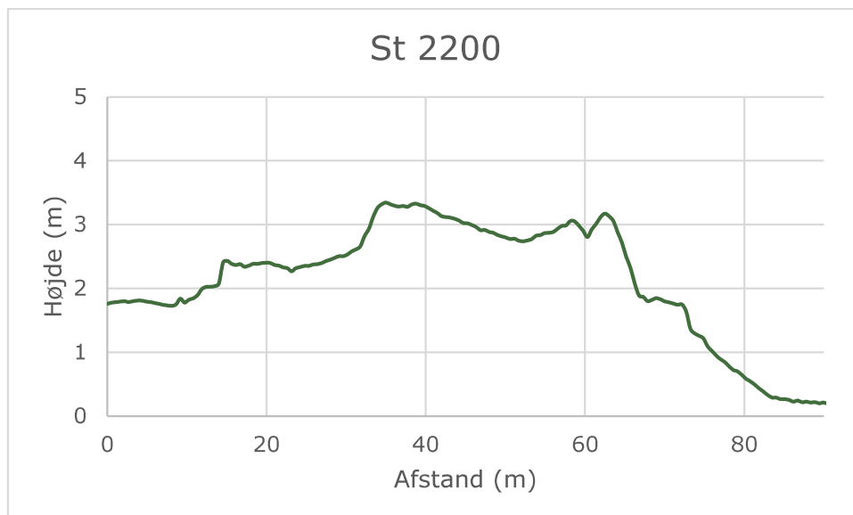
Figur 16 Tværsnit af diget St 2200
